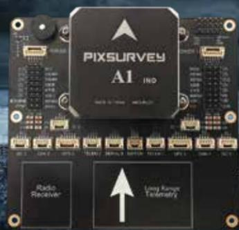
PixPilot V3飞控系统是在开源飞控FMU V3的基础上开发的一款通用型飞控，采用稳定可靠的F427处理器，全面提升IMU传感器性能，适应更多工作环境。具有性能稳定、装机简洁、使用人性化的特点。
