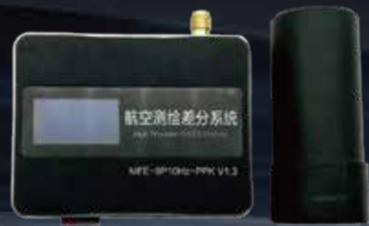
PPK为Post-Processing Kinematic的简称（GPS动态后处理差分）利用载波相位进行事后差分的GPS定位技术，其系统也是由基准站和流动站组成，外业测量时不需要在流动站和基准站之间建立实时的通讯链接，作业半径大，在流动站上进行短时间的观测即可解算出厘米级的精度。
